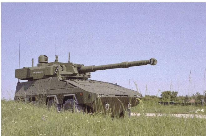
pointage et le chargement se fait de manière entièrement automatique. Des essais en 2021 ont démontré que le système pouvait être entièrement engagé à distance, sans équipage à son bord. A l'instar de son prédécesseur chenillé, la pièce emportée est une arme de 155 mm L55.
