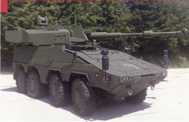
Destiné à l'appui direct de formation d'infanterie motorisées, l'adaptation d'une tourelle de 105 mm sur le châssis du *Boxer* permet de mettre en oeuvre des formations intégrées et homogènes, à la fois très mobiles et très réactives. Photos © KMW.
