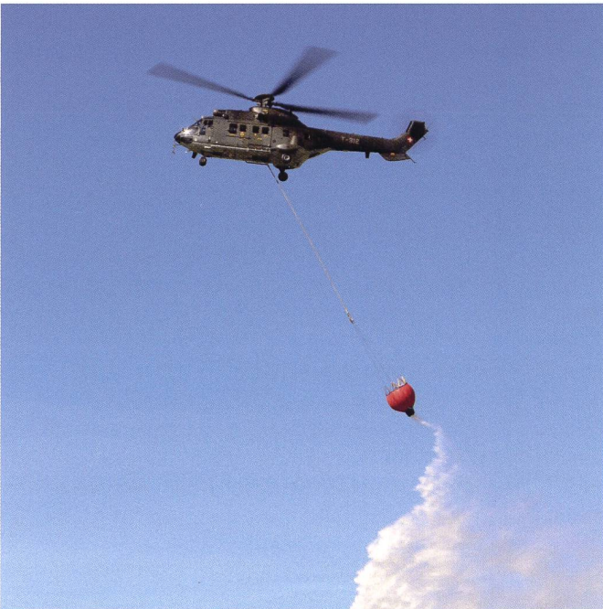
Le Super Puma est souvent utilisé pour la lutte contre les incendies. Grâce au bambi bucket , il peut déverser jusqu'à 2500 litres d'eau sur un feu.
