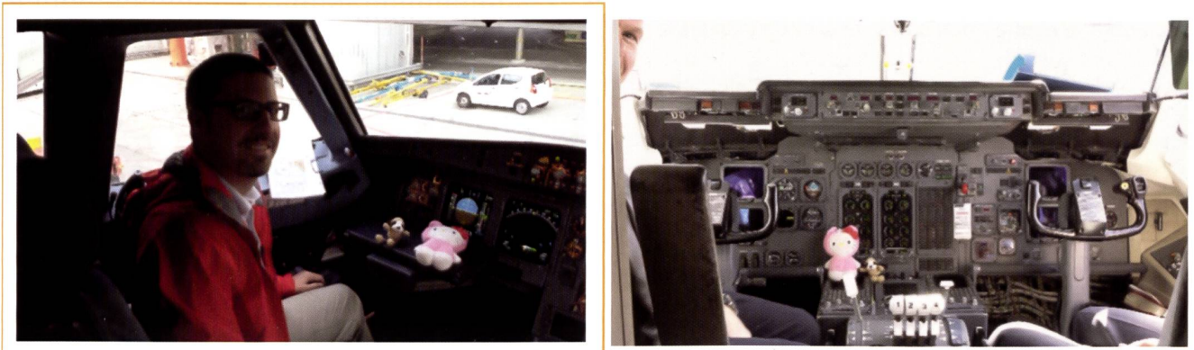
Figure 1 : Exemples de cockpits d'avions commerciaux, à gauche un Airbus A320 et à droite un British Aerospace 146. Sur l'Airbus, les commandes de vol sont placées sur le bord extérieur du cockpit, peu visibles ici et encore moins assis dans le siège du copilote, alors que sur le British Aerospace les commandes sont centrales et bien visibles en position assise. Les actions produites par un pilote ne sont pas détectables de la même manière selon la configuration du cockpit.
