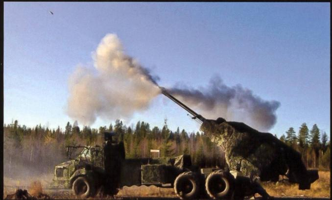
L'obusier autopulsé Archer est un système d'artillerie de 155 mm / L52 capable d'être mis en action très rapidement et de tirer des rafales de 3 à 15 coups extrêmement rapides. L'équipage complet se limite à trois hommes car toute la manutention des obus est automatisée.
