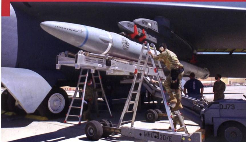
Juin 2019 : Essai de tir du Air-Launched Rapid Response Weapon (ARRW) américain AGM-183, lancé par un B-52. Le missile vole à Mach 5 (6'125 km/h) puis son 2<sup>e</sup> étage atteint Mach 20 (24'696 km/h) et peut frapper une cible à 1'600 km de distance.
