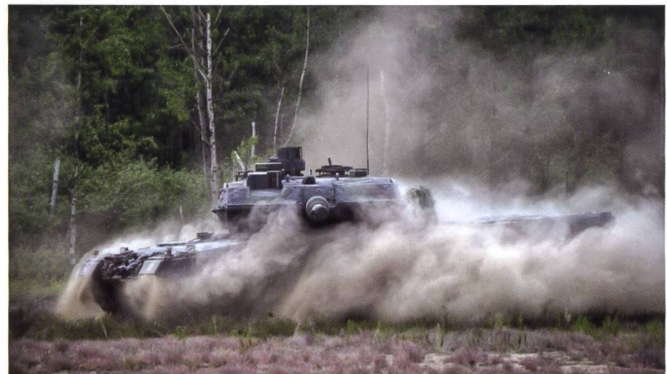
La Pologne a également reçu 105 Léopard 2 A5 (ci-dessus), qui se distinguent par un blindage supplémentaire sur la tourelle.
