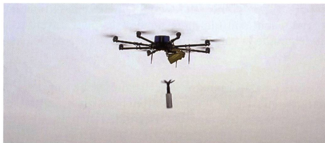
Un R18 Octocopter de la société ukrainienne Aerozvidka. Le système permet de viser et de lâcher une bombe non guidée armée d'une charge creuse.
