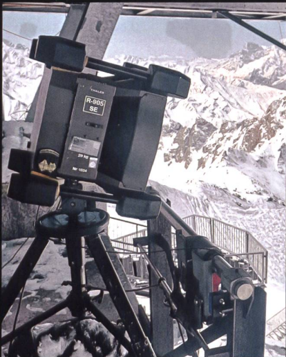
Ce R-905 permettait de relier la vallée à l'antenne du réseau 4G sur la PdG.
