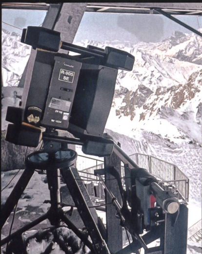
Ce R-905 permettait de relier la vallée à l'antenne du réseau 4G sur la PdG.
