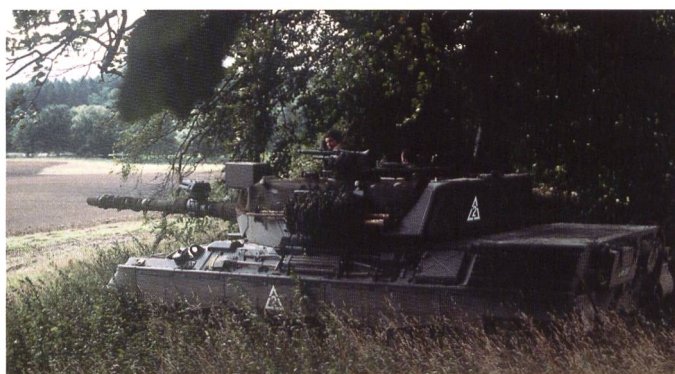
Un Léopard 1A3 danois en embuscade. Les versions A3 et A4 sont reconnaissables à leur tourelle anguleuse, plus large et renforcée.
