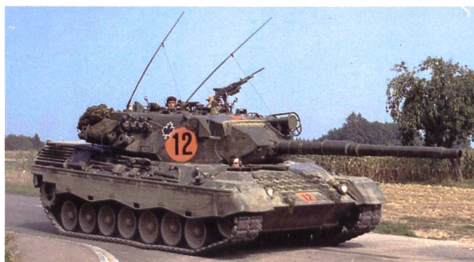
Le Canada a reçu 114 Léopard 1A3 renommés localement C1 en 1978-1979. Plus tard, 66 engins ont été modernisés au standard C2 en leur ajoutant une tourelle A5 ainsi qu'un blindage renforcé.
