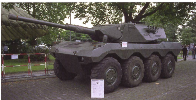
Le prototype du Radpanzer 90 était un concept destiné à adapter la tourelle du Léopard 1A3 sur un châssis 8x8 similaire à celui de l'engin de reconnaissance Luchs . Trop lourd et trop encombrant, sa mobilité était décevante et il n'a jamais été commandé.
