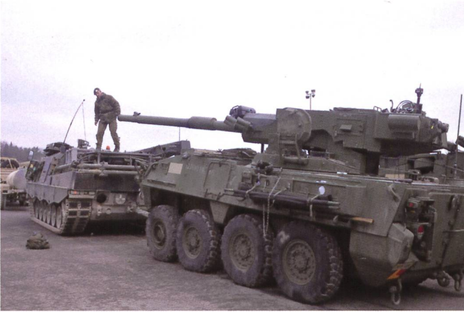
Fin d'exercice peu glorieux pour ce M1128 du 2 nd CR remorqué par un Búffel de la Bundeswehr. La suspension arrière a lâché et les crochets d'attelage touchent le sol. Photo © Sgt. Thomas Johnson.
