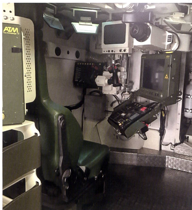
Le poste de commande de la tourelle téléopérée Lance de Rheinmetall, installé sur le Boxer . Le KF-51 est doté du même système.
