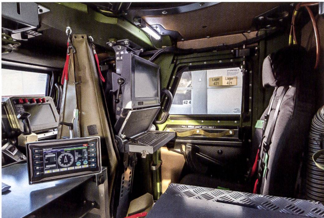
Intérieur de la cabine de l'Eagle V 6x6 TASYS avec la station INTAFF sur la place arrière droite et la station de commande du système d'arme KONGSBERG sur la place avant droite. $il est possible de faire coulisser de gauche à droite la manette de contrôle de la KONGSBERG, cette dernière pouvant s'adapter ainsi aux gauchers comme aux droitiers.
