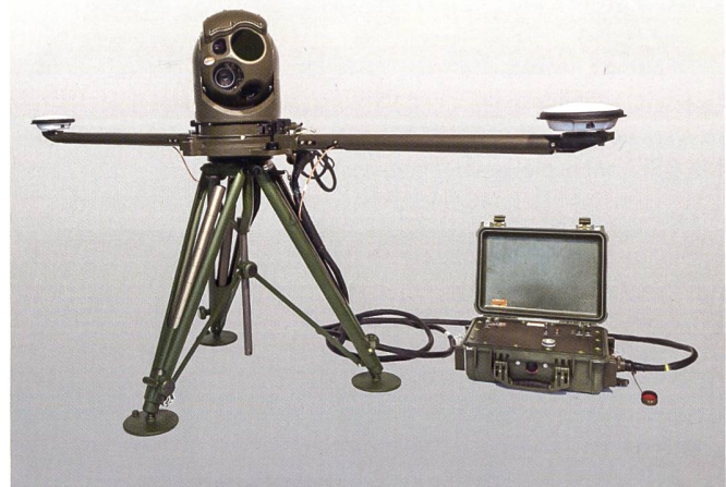
La WESCAM MX RSTA démontée du mât du véhicule et fixée sur son trépied.
