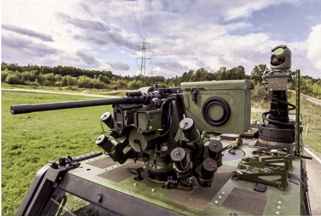
Le toit du véhicule eagle V 6x6 TASYS avec, au premier plan, le système d'arme KONGSBERG et, au deuxième plan, la WESCAM MX RSTA sur le mât légèrement déployé.
