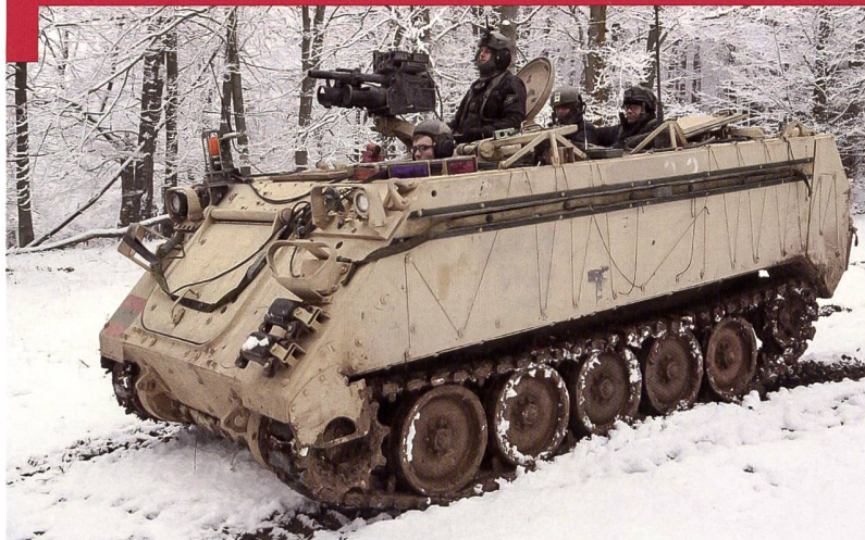
M-113 A2 encore en service dans l'armée américaine. La version se distingue par des réservoirs de carburant extérieurs, un nouveau moteur et un compartiment du pilote revisité. Cet engin est équipé du simulateur à double action MILES. Afin de donner à l'engin un minimum de capacité défensive, un affût jumelé à la mitrailleuse M2HB permettait de pointer et de tirer un engin filoguidé antichar Dragon . Photo © US Army.
