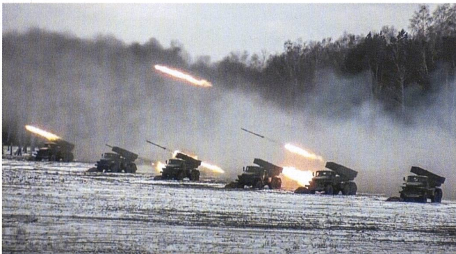
Tir d'une batterie complète de BM-21. Chaque véhicule peut tirer 40 fusées à une distance de 17 km au maximum, à un rythme de deux coups par seconde.
