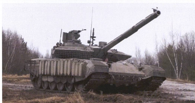
Ci-dessus : T-90 M reconnaissable à son blindage de 5 e génération et son périscopes indépendant/WBG pour le commandant. La photo du haut permet de voir plusieurs T-14 au second plan.
