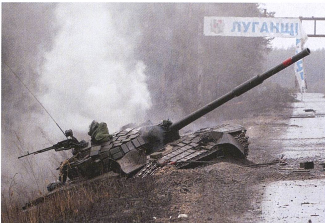
Un T-72 B recouvert de blindages réactifs Kontakt 1 sort de sa position de feu. Malgré les vitesses de pointe élevées, supérieures à 60 km/h sur route, tous les T-72 et T-90 sont limités par une boîte de vitesse ne disposant que d'une seule marche arrière, limitée à 5-6 km/h.
