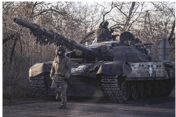
Le T-72 BM2 introduit des composants de T-80 sur la base du T-72 plus ancien.
