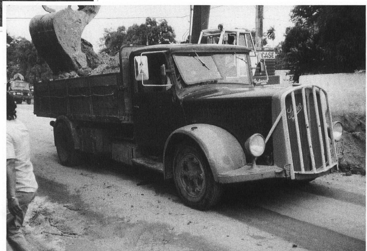
Saurer 3C mit fester Brücke, eingesetzt im Kipperbetrieb: Kippen? Nein, mit Schaufeln wieder alles abladen.
