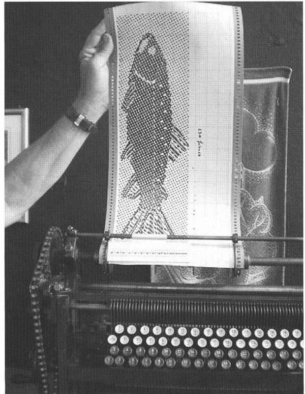
Auf der Kartenschlagmaschine wurde nun dieser 230 schussfadenlange Rapport geschlagen. Reihe um Reihe mittels der Tastatur, Nr. 1 bis Nr. 64, mit drücken der jeweiligen Taste bestimmt werden, ob der Kettfaden gehoben werden muss. Ein Loch in der Karte bedeutet Kettfaden gehoben. Dieser Rapport wurde dann sechsmal kopiert, also sechs Fische in jeder Bordüre. Am Anfang und am Ende des Tüechlis benötigten wir noch ein paar Hundert Schuss zum säumen.
