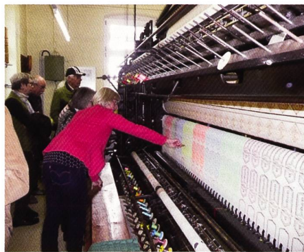
Vorderseite der riesigen Schiffli-Stickmaschine VOMAG von ca. 1910
