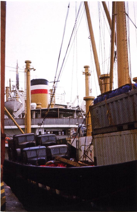
Aufeinander gestapelt treten die Lastwagen den Weg über den Atlantik nach Brasilien an. Während der Überfahrt sind sie Wind und Wetter ausgesetzt, was aufwendige Korrosionsschutzmassnahmen notwendig machte.
