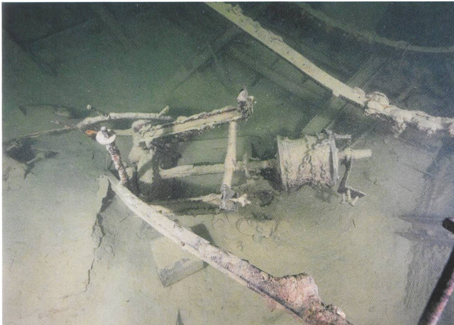
Steuerruder, Kraftübertragung vom Rad auf das Ruder
