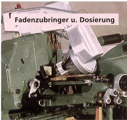
Bild 4: Das neuentwickelte Aggregat für die Fadenübergabe
