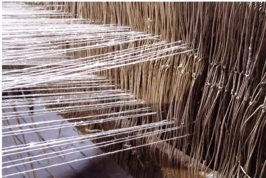
Fachbildung durch die gehobenen und gesenkten Kettfäden
