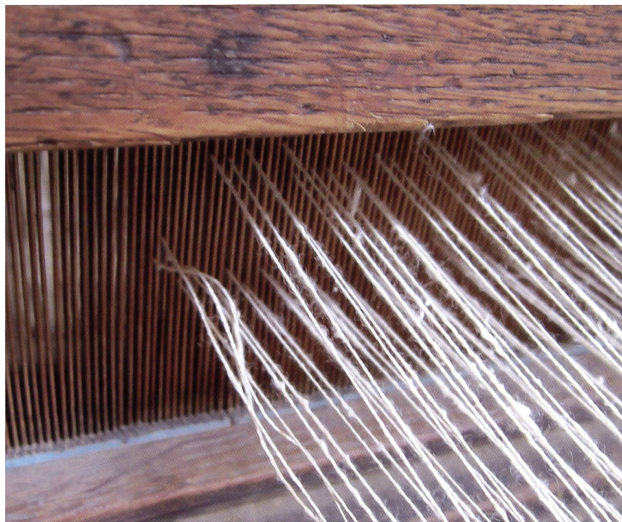
Das Webblatt aus geschnittenem Schilfrohr
