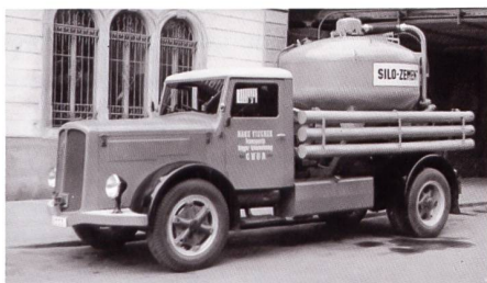
SAURER V8 1944 ex Wehrmacht mit Siloaufbau 5t System Klingler
