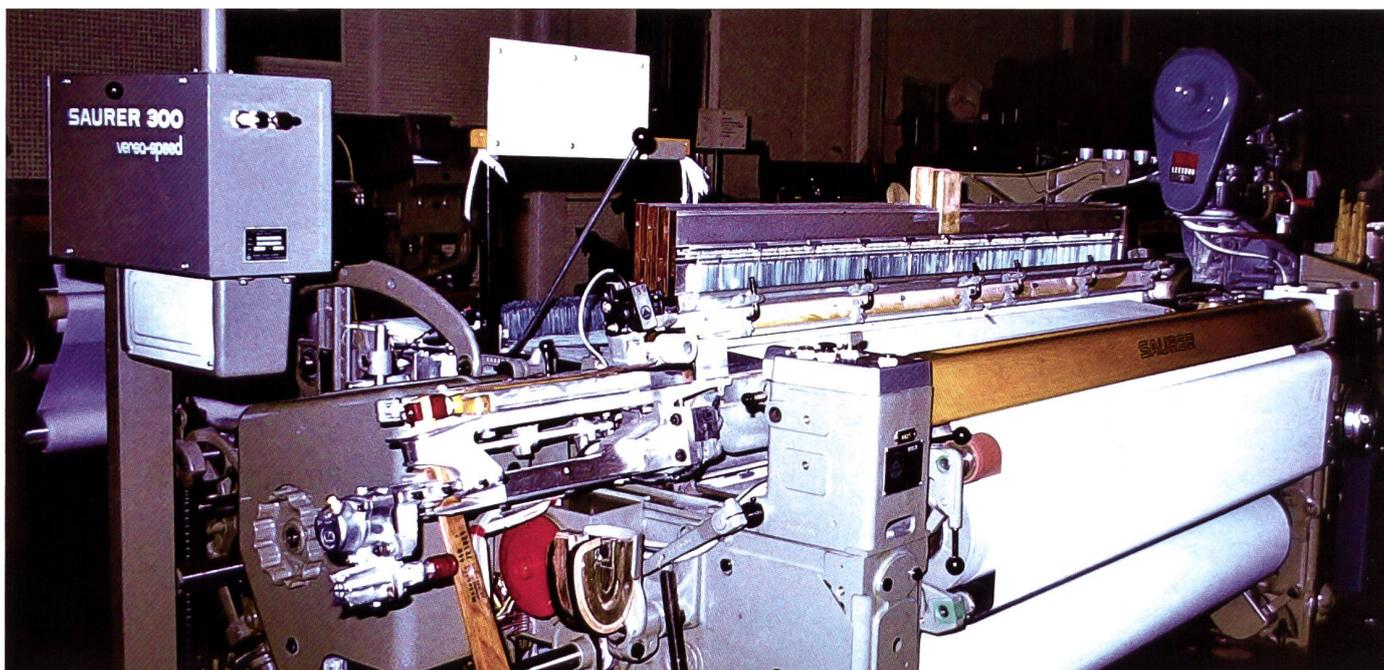
Die S300 von der Antriebsseite her. Der Antrieb ist vollständig verschalt, nur das Handrad schaut heraus. Daneben sichtbar der rote Zentralschalter. Der Steuerkasten steht zur Vermeidung von Vibrationen neben der Maschine.
