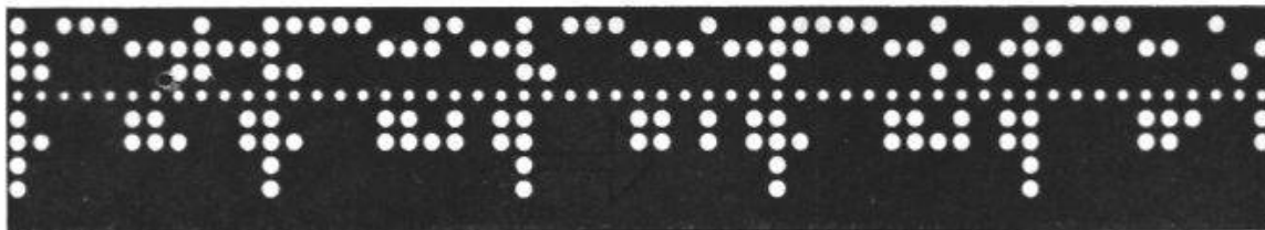
Fig. 8. Fragment de bande perforée contenant des résultats d'analyse.
