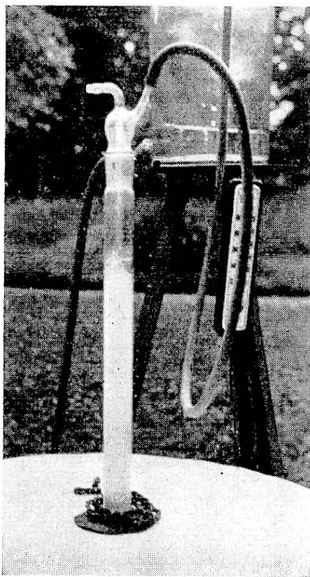
Abb. 2. Die rasche Schaumbildung in der Absorptionsröhre während der Luftprobenentnahme innert 1\frac{1}{2} Minuten.
