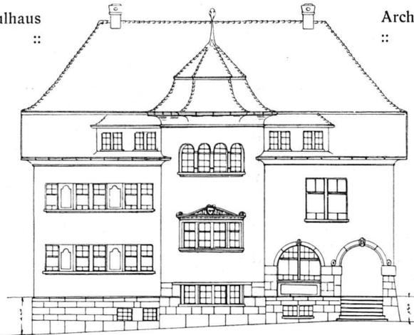
Geometrischer Aufriss der Nordfassade. — Massstab 1 : 300.
