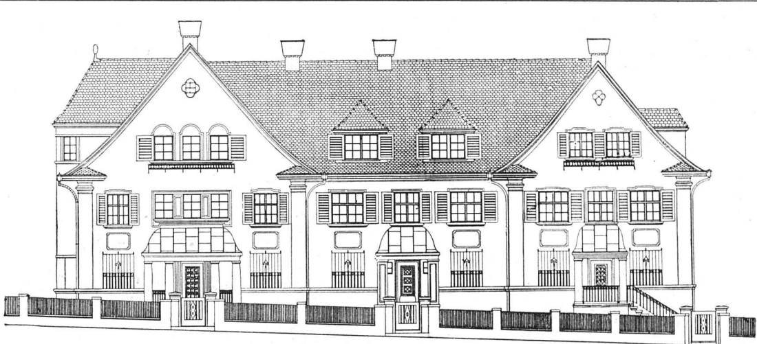
Aufriss der Fassade gegen die Hadlaubstrasse. — Masstab 1 : 250.
