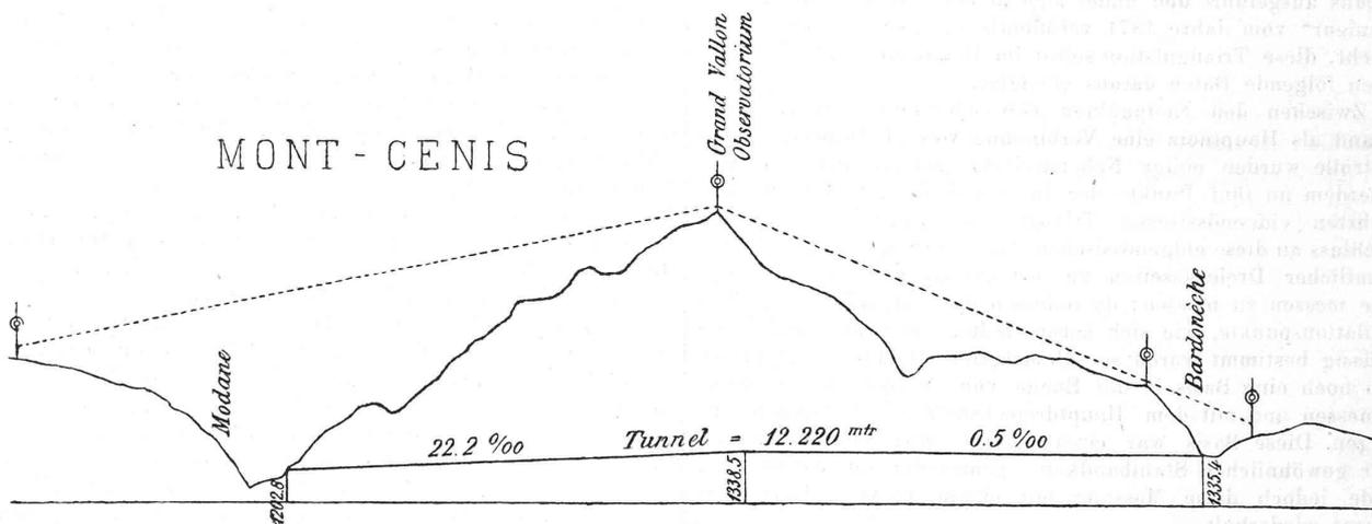
Es wurden hier zuerst versuchsweise über das Bergmassiv, das der Tunnel zu durchfahren hatte, einige Linien abgesteckt, bis man eine erhielt, welche ungefähr durch die beiden projectirten Tunnelmündungsstellen ging. Diese provisorische Richtung benutzte man, um auf dem höchsten Punkt, dem Grand-Vallon, ein Observatorium zu errichten und von ihm aus mittelst eines grössern Theodolithen zu beiden Seiten rückwärts der Mündungen Punkte zu bestimmen. Waren diese
