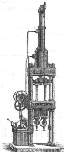
Hydraulische Maccaronipressen, Knetmaschinen, Teigandrührmaschinen,
