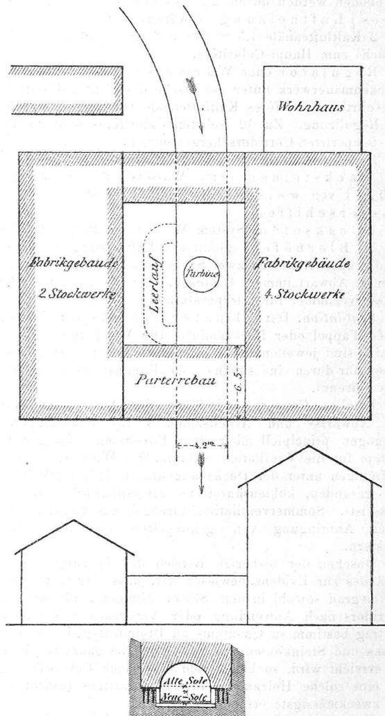
Bei Gelegenheit der Ausführung dieser Turbinenanlage sollte gleichzeitig das nutzbare Canalgefälle von circa 2 auf 2 1/2 Meter gebracht werden. Der Boden der Turbinenkammer selbst war
