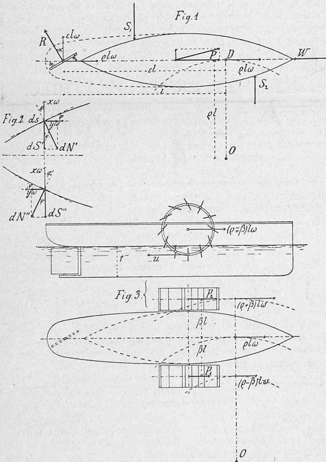
1. Die Triebkraft  $P$  in der Längsaxe des Schiffes, wie z. B. bei einem Schraubenschiffe. Es soll angenähert vorausgesetzt werden,  $P$  sei in der Curve genau gleich gross, wie in der Geraden. Ist dann  $F$  der Querschnitt des Hauptspantes,  $c_0$  die Geschwindigkeit des Schiffes in der Geraden,  $z$  ein Erfahrungcoefficient, so kann man bekanntlich die zur Fortbewegung des Schiffes nöthige Kraft angenähert setzen:
