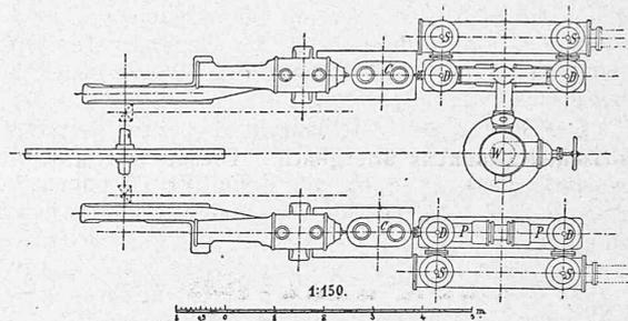
belastet, und von Hand verstellbar, da die Arbeit der Maschine so zu sagen eine gleichmässige sein wird. Diese Steuerung besitzt keine Luftpuffer, noch Ausrückung, noch Spiralfedern. Alle Bewegungen sind zwangsläufig. Sie erlaubt mit dem Füllungsgrad zwischen 0—0,65 zu variiren.
