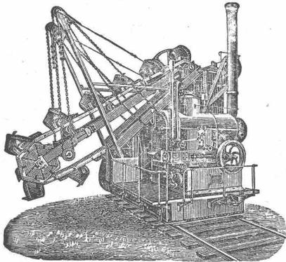
Leistung: 2000 cbm in leichtem, und 1500 cbm in sehr schwerem Boden. Der Apparat schüttet baggernd und langsam fahrend den ruhenden normal oder schmalspurigen Arbeitszug voll. Apparat bedienung 3 Mann, Kohlenverbrauch 15 bis 20 Ctr., zum Schienenverlegen 10 Mann. Diese sämtlichen Unkosten betragen pro Tag incl. Amortisation 60—70 Mark.
