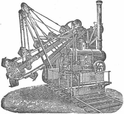
Leistung: 2000 cbm in leichtem, und 1500 cbm in sehr schwerem Boden. Der Apparat schüttert baggernd und langsam fahrend den ruhenden normal oder schmal-spürigen Arbeitszug voll. Apparatbedienung 3 Mann, Kohlenverbrauch 15 bis 20 Ctr., zum Schienenwerfen 10 Mann. Diese sämtlichen Unkosten betragen pro Tag incl. Amortisation 60-70 Mark.
