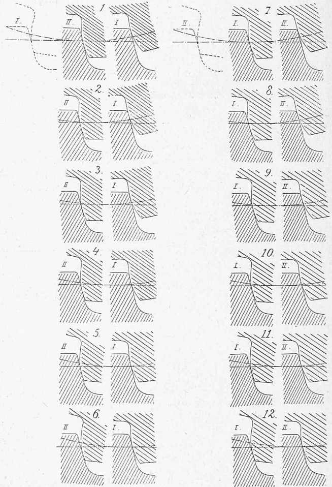
Gleichzeitige Eingriff-Stellungen des zweitheiligen Zahnrad-er in Distanzen von 10 mm.
