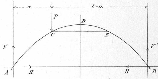
la figure 1. ci-contre, que l'allongement de l'arc produit par  $V'$  sur le segment  $CD$  est égal au raccourcissement du segment symétrique  $DE$ , et comme  $AC = BE$ , nous aurons
