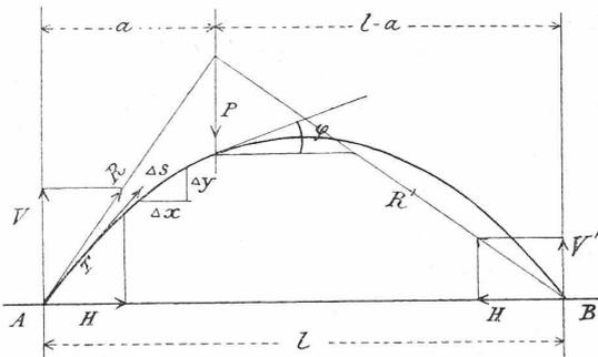
Si nous admettons que la section de la nervure de l'arc, que nous désignerons par  $\frac{1}{2}F$ , soit concentrée autour de son centre de gravité, et si nous appelons  $d$  la demi-distance des centres de gravité des nervures, nous pourrions poser
