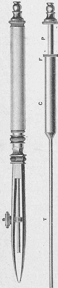
Im hohlen Stiele der Feder befindet sich ein mit Tusche anzufüllender Cylinder *C*, dessen Verlängerungsröhre *T* zwischen die Spitzen der Feder führt und dieselben beim Drücken auf den Kolben *P* mit Tusche speist.
