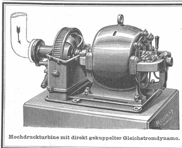
Hochdruckturbine mit direkt gekuppelter Gleichstromdynamo.
