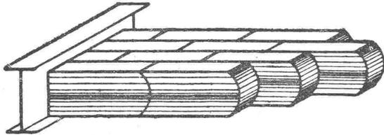
Dieses neue, geradlinige, massive Deckensystem zeichnet sich durch **grösste Einfachheit** aus. Es ist nur ein Formstein notwendig, kann von jedem tüchtigen Maurer ohne Schalung mit Kalkmörtel ausgeführt werden. Beliebige Trägerdistanzen von 0,5—2,5 m. Grosse Nutzlast und Eisensparnis.
