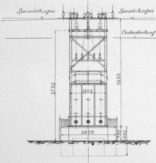
Fig. 12. Transformerturm von der Bahn gesehen. 1:100.
