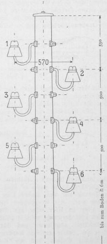
Fig. 6. Anordnung der Hochspannungsleitung. 1 : 20.
