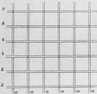
werden als wichtig erachtet, um die Adhäsion zu vermehren, das Gleiten des Betons längs den Hauptstäben zu verhindern und eine Lastverteilung zu bewirken. Bei Deckenkonstruktionen, welche auf allen vier Seiten aufliegen, kommen die Verteilungsstäbe auch statisch zur Wirkung.
