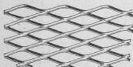
Auch dieses ist ein eisernes Maschenwerk (Fig. 3—5), jedoch mit festen Knotenpunkten, welches maschinell erzeugt wird und zwar aus dem Vollblech durch parallele Einschnitte mit
