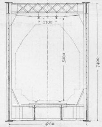
Fig. 18. Leitungs-Anordnung auf der Aarebrücke bei Thun. 1:125.
