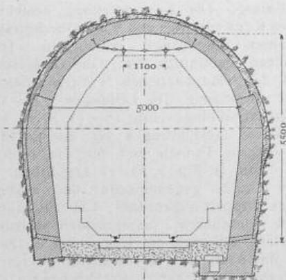
Fig. 17. Leitungs-Anordnung im Tunnel. 1:125.
