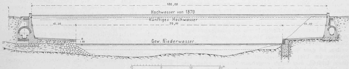
Fig. 1. Ursprünglich von der Kommission vorgeschlagenes Normalprofil. 1:600.
