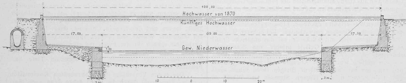
Fig. 2. Von der Unternehmung vorgeschlagenes Normalprofil. 1:600.
