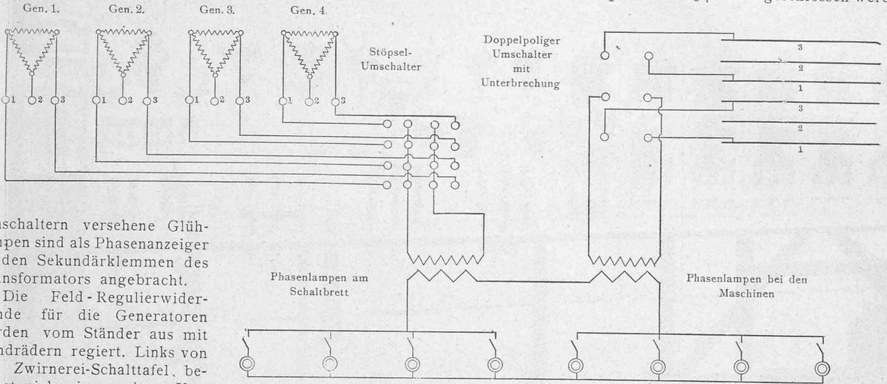
Abb. 8. Schema der Transformatoren für die Phasenvergleichung.
