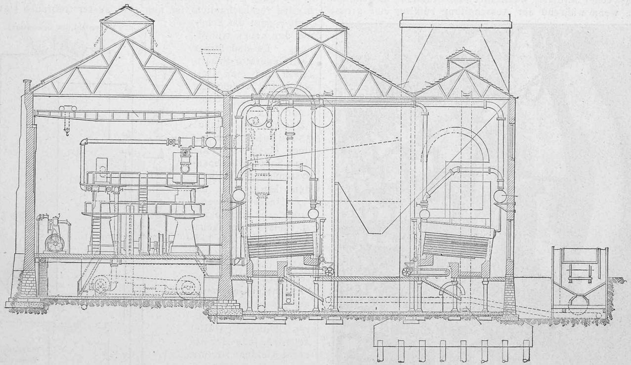
Abb. 10. Querschnitt durch Maschinen- und Kesselhaus. 1:350.
