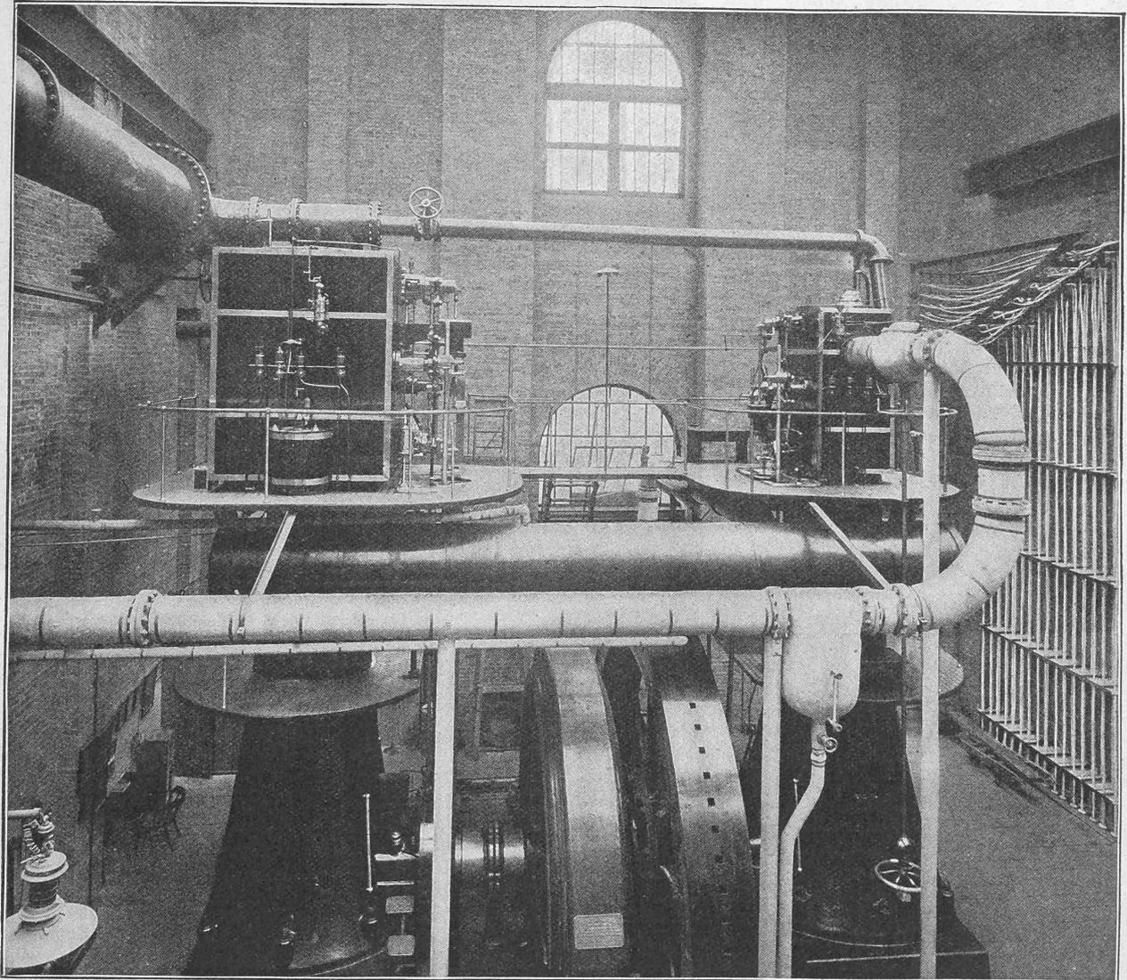
Abb. 5. 1100 kw-Innenpol-Generator, gekuppelt mit einem Kreuzverbund-Corliss-Dampfmotor, System Allis.
