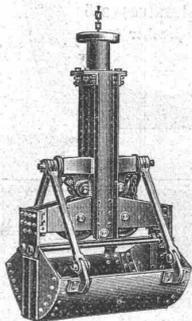
Diese Apparate dienen zum Aushub des Erdreichs aus Baugruben, Senkbrunnen u. s. w. Dieselben können durch einen gewöhnlichen **Kran**, event. auch durch eine **Winde** bedient werden.
