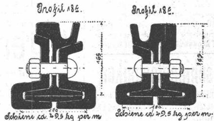
Die bisherige beste Lösung der Stossfrage ist Anwendung der Fusslaschen. Die Fusslasche garantiert dauernd stossfreies Befahren. Weichen und Kreuzungen bewährtester Bauart mit neuester Zungenbefestigung, Federung, Entwässerung und mech. Umstellvorrichtung System Phoenix, Normale Verlaschung mit Blattstoss-Halbstoss bezw. Fusslaschen an allen Weichenstössen. Auflaufweichen zu Notgleisen. Hilfsgeräte zu Gleisverlegungsarbeiten, Lochpresse, Biegebügel.
