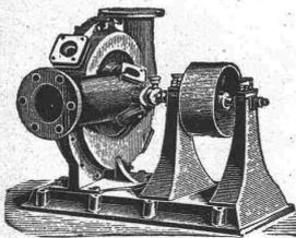
zum Fördern von schmutzigem und feste Bestandteile enthaltendem Wasser. Steine etc. zur Größe von ein Drittel des Saugrohr-Durchmessers gehen durch dieselbe hindurch, ohne sich festklemmen zu können.
