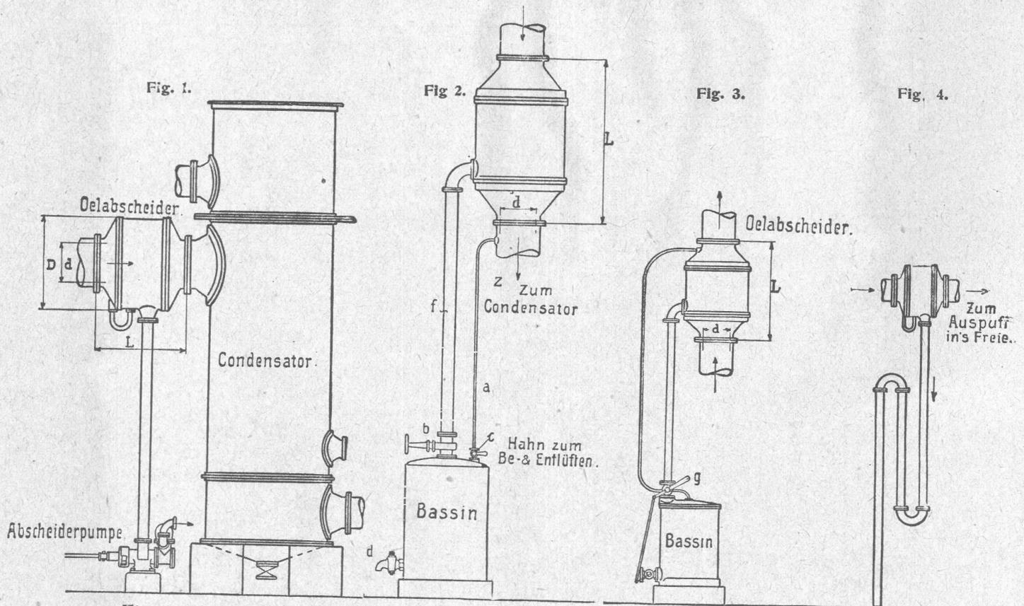
**Fig. 1** zeigt die Einschaltung eines Ölabscheiders in horizontaler Leitung unmittelbar vor einem Oberflächen-Kondensator. Die Entfernung des abgeschiedenen Öl- und Wassergemisches erfolgt durch eine Abscheiderpumpe, deren Antrieb von irgend einer hin- und hergehenden Bewegung oder auch mittels eines Exzenters von der Transmission aus bewirkt werden kann.
